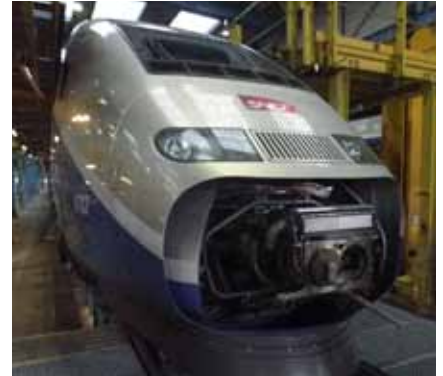
Attelage automatique Scharfenberg reliant deux rames TGV
